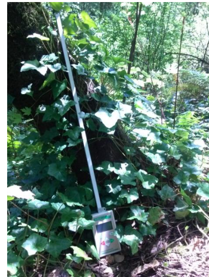
Photo 2: LP-80 LAI & PAR sensor. Photo courtesy of Laura Holloway.
