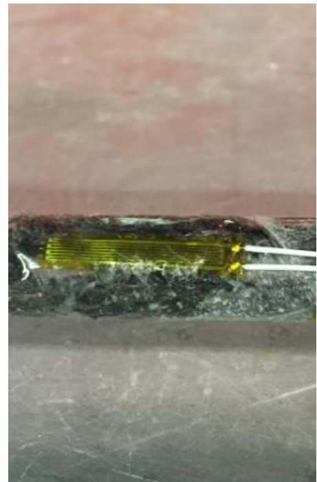
(D) A strain gauge is installed
