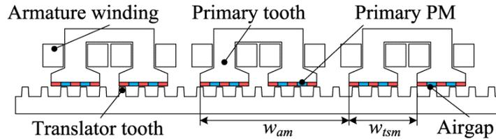
Fig. 1-13. A modular linear PM Vernier motor [28].
